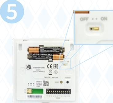
Batterien (im Lieferumfang enthalten) ins Batteriefach einsetzen und Raumthermostat einschalten
