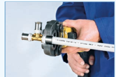
4) Pressbacke mit der breiten Nut am Kunststoffring des Fittings aufsetzen
